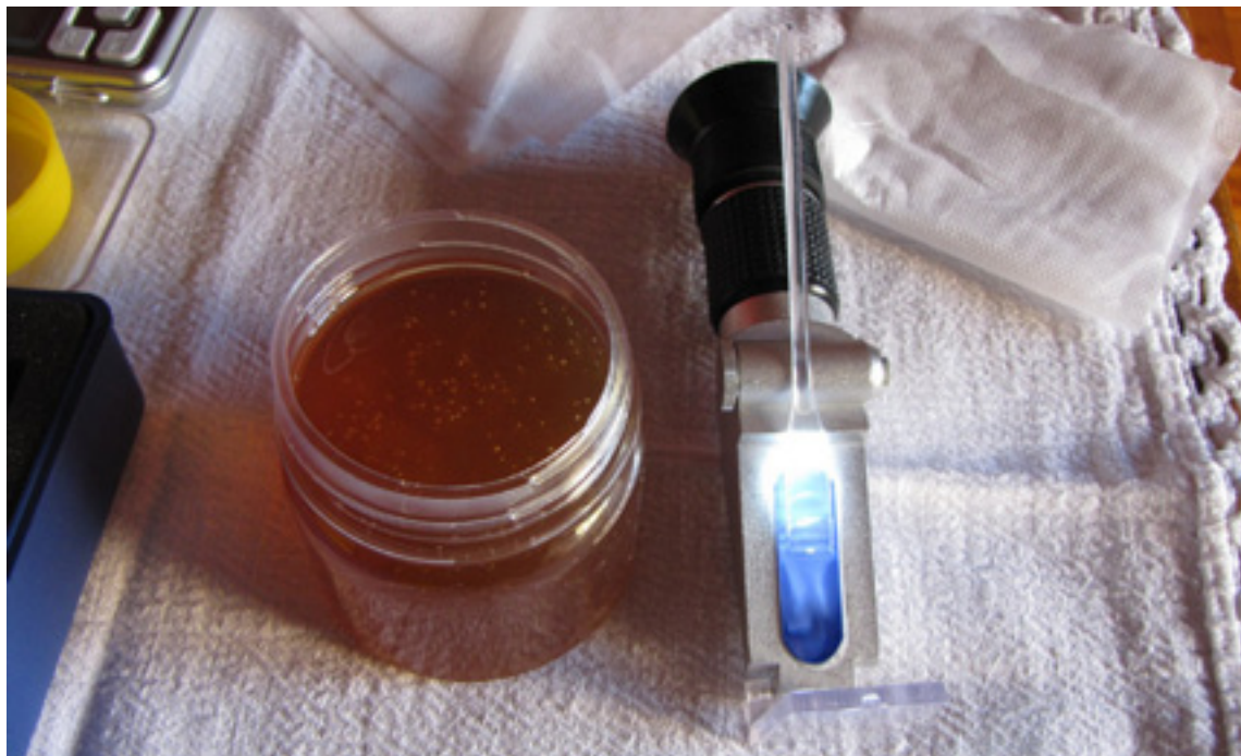
La humedad en la miel se puede determinar usando un refractómetro de mano, el cual expresa su porcentaje en grados brix (°Bx)
